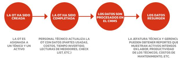
Fig. 7 – Proceso que sigue un sistema CMMS a partir de una orden de trabajo (OT) asignada.
